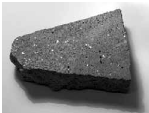
Obr. 71. Zachovat, případně citlivě opravit je třeba i autentické povrchové úpravy venkovních komunikací, které jsou součástí areálu památek moderní architektury. Úlomek cementového potěru s lesklými šupinkami slídy je bohužel jediným zbytkem efektní povrchové úpravy, jež nebyla při opravě chodníku lázeňské kolonády obnovena.
