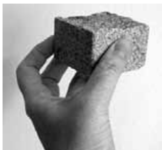
Obr. 66. Novodobá strojově vyráběná řezaná chodníková mozaiková kostka o hraně 6 x 6 cm. Kvůli úspoře materiálu má výšku pouze 4 cm. Kostku lze po ošlapání jen jedenkrát obrátit.
